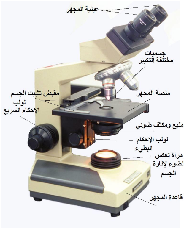
الشكل 3. مجهر مركب بثلاث جسميات يسمح للمستخدم
