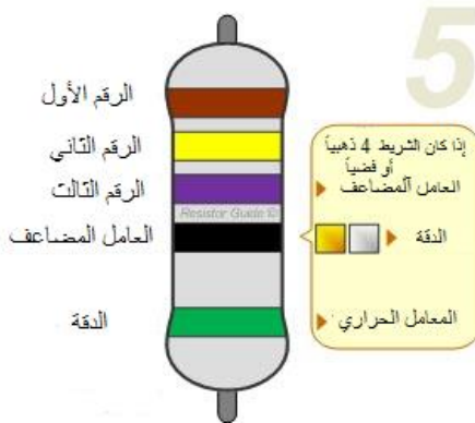
الشكل 5. الترميز اللوني للمقاومة
