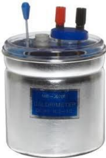
الشكل 2. مسعر كهربائي
