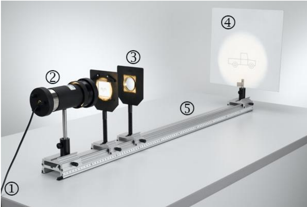
الشكل 12. ترتيب أجهزة التجربة. (1) منبع تغذية للمصباح، (2) مصباح إنارة مع الجسم، (3) عدسة، (4) حاجز، (5) جسر ضوئي.
